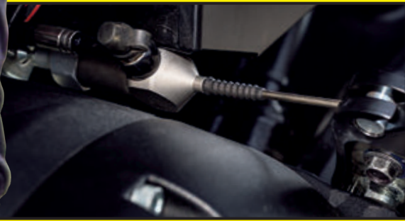
PM American Cycles verwendet eine hydraulische Kupplung. Jetzt reichen zwei Finger, bei minimalen Hebelkräften
